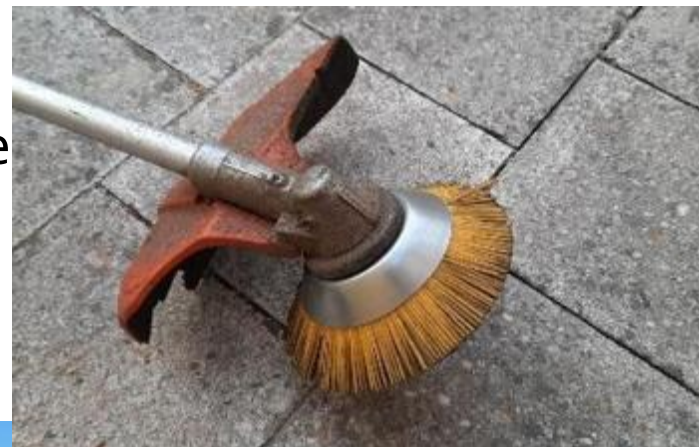
Obr. 3. Mierne narušenie mačiny možno vykonať aj kefovým nástavcom na krovinorez, ktorý sa bežne používa na odstraňovanie buriny z dlažby.
