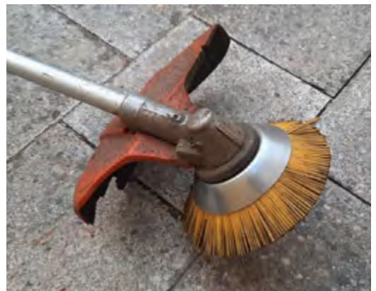
Obr. 117. Mierne narušenie mačiny možno vykonať aj kefovým nadstavcom na krovinoreze, ktorý sa bežne používa na odstraňovanie buriny z dlažby (fotografia: Vilém Jurek).
