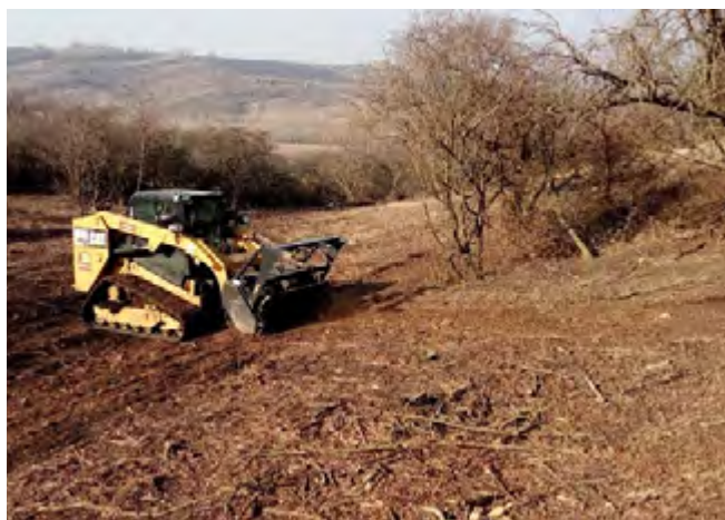
Obr. 32. Frézovanie pomocou čelného adaptéra (ÚEV Horky; fotografia: Vilém Jurek).
