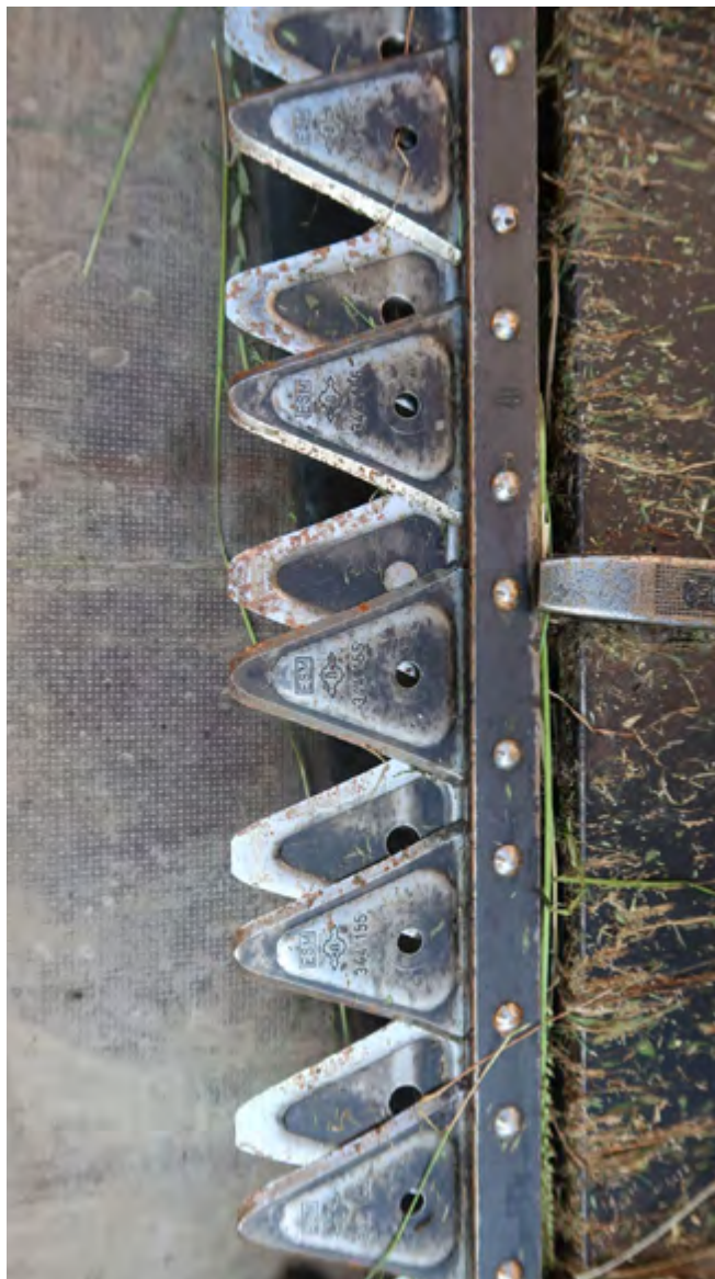
Obr. 11. Lišta s protibežnými nožmi (fotografia: Stanislav Hejduk).
