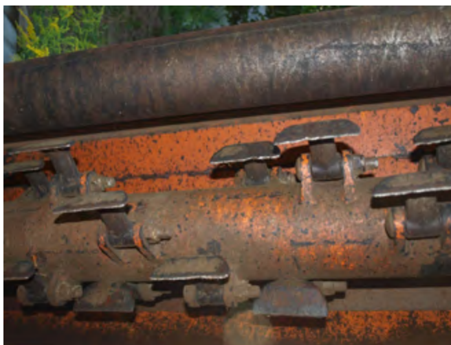
Obr. 55. Kladivkový mulčovač s oporným valcom, na ktorom je možné nastaviť výšku ponechaného strniska (fotografia: Stanislav Hejduk).
