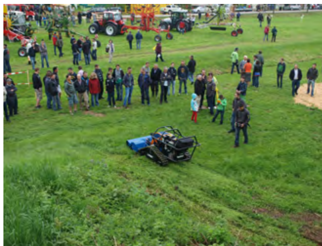
Obr. 56. Diaľkovo ovládaný samohybný mulčovač pre ťažko dostupné plochy (fotografia: Stanislav Hejduk).
