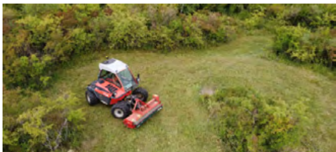
Obr. 52. ÚEV Kamenný vrch: vľavo cepákový mulčovač na stroji Reform; vpravo vyhrabávanie rozdrvenej biomasy po mulčovaní (fotografia: Vilém Jurek).
