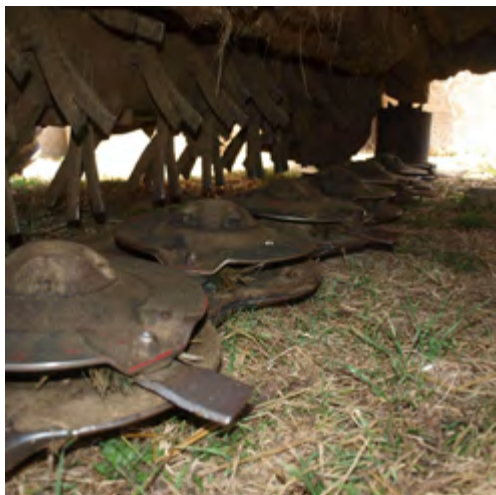
Obr. 13. Vľavo: Diskové žacie ústrojenstvo s prstovým kondicionérom (fotografia: Stanislav Hejduk).
