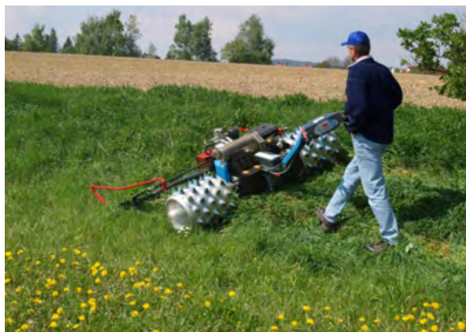
Obr. 9. Ručne vedená jednonápravová kosačka s úpravou kolies na kosenie silne svahovitých trávnych porastov (fotografia: Stanislav Hejduk).
